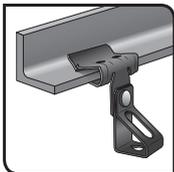
1. Fixer le clip de fixation sur le support métallique
