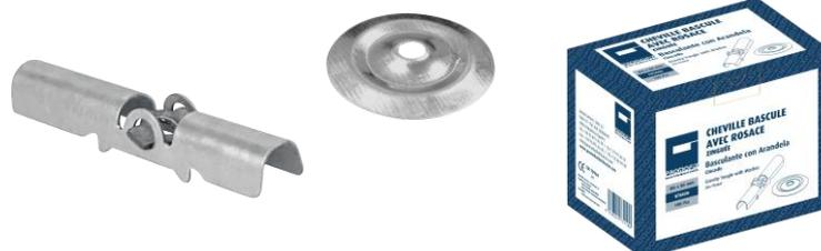
Système de fixation comportant 2 pièces, pour la suspension de tiges filetées M6, dans des plafonds creux, type plaques de plâtre, briques creuses ou hourdis. La bascule possède un taraudage M6 pour le serrage de la tige filetée. La rosace possédant un trou dans son centre pour le passage de la tige filetée M6 et son blocage. Installer ce système de fixation selon le DTU 58-1 et respecter les charges admissibles.
